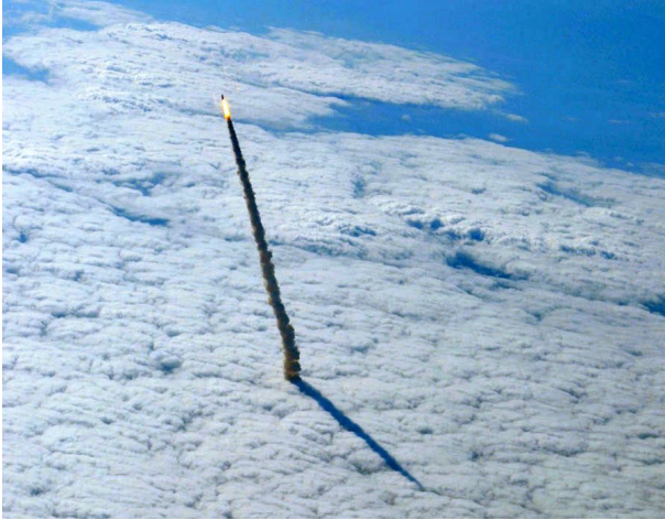
Fig. 6.5: Die Aufstiegsbahn einer Rakete (Space Shuttle) ist eine genau vorgegebene Flugbahn, die durch Schwenkung der Triebwerke ( gimbaled thrust ) genau verfolgt wird.
