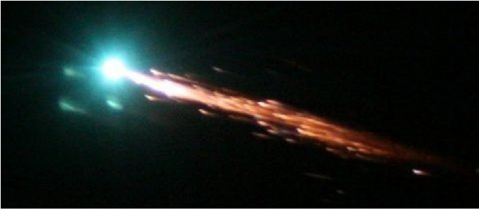
Fig. 5.11: Der kontrollierte Absturz des 14 Tonnen schweren ATV-002 Frachters „Johannes Kepler“ von der Internationalen Raumstation im Juni 2011. Da einige Details des Verglühens in der Erdatmosphäre bis heute nicht gut verstanden sind, hatte er einen „Reentry Break-up Recorder“ an Bord. In etwa 80 km Flughöhe brach allerdings der Kontakt ab. (Bild: ESA)
