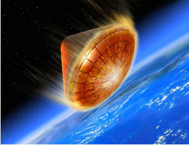
Fig. 5.7: Die Apollo - Raumkapseln mussten beim Wiedereintauchen in die Erdatmosphäre mit über 10 km/s Geschwindigkeit einen sehr flachen Eintauchwinkel einhalten, der in 100 km Höhe nur etwa 5.5 bis 6.5 Grad Neigung zur Erdoberfläche hatte. (Bildquelle: NASA)
