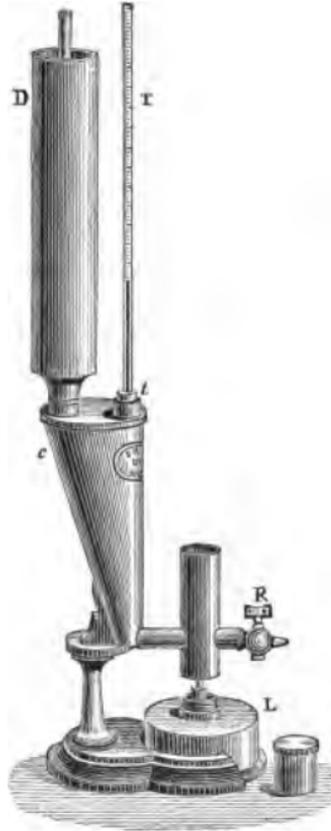
Fig. 15. — Ebullioscope de Salleron.
