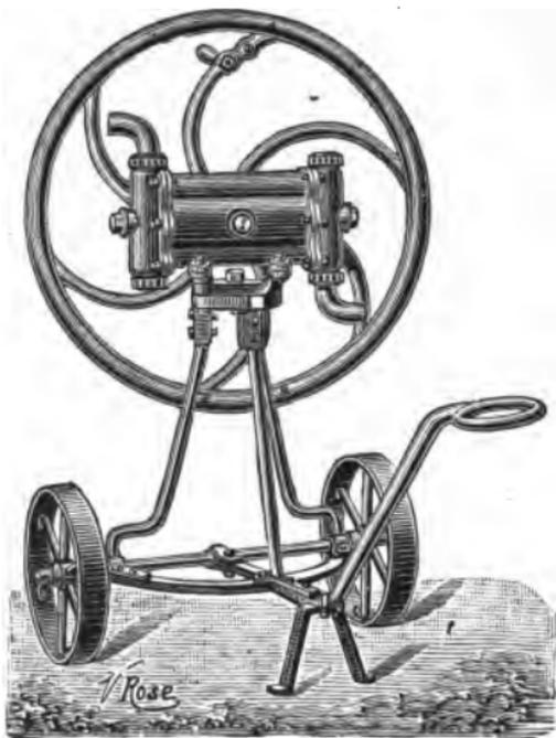
Fig. 10. — Pompe roulante, aspirante et foulante.
