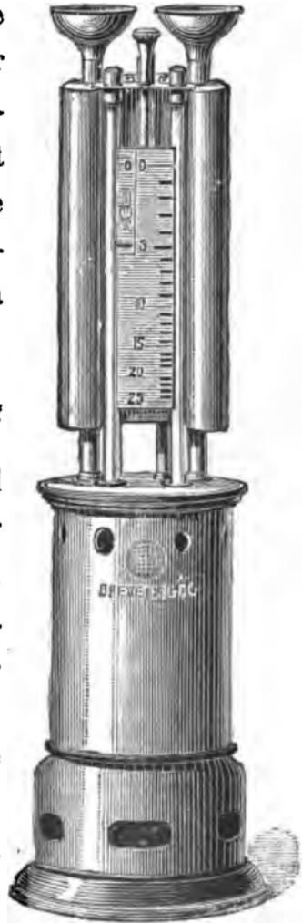
Fig. 17. —Ébullioscope de M. Amagat.
